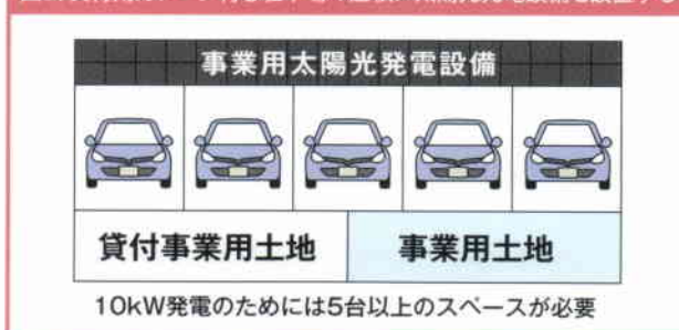
図2. 貸付用ガレージ付き駐車場の屋根に太陽光発電設備を設置する
